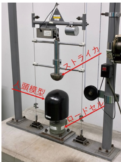
図1 飛来・落下物用衝撃吸収性試験装置
