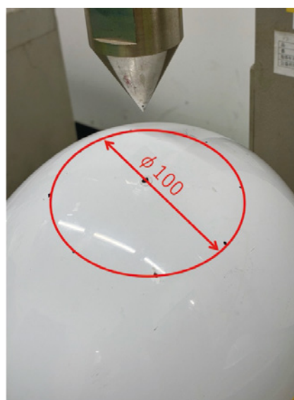
図5 耐貫通性試験箇所
