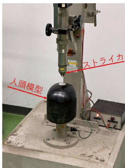
図4 飛来・落下物用耐貫通性試験装置
